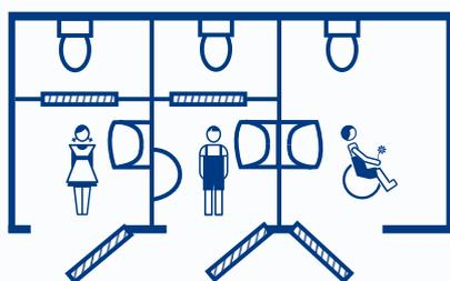
Dieser WC Container entspricht in seiner Qualität der Pipibox XL und ist durch ein weiteres barrierefreies WC für Rollstühle geeignet. Eine Handlaufleiste hilft bei der
